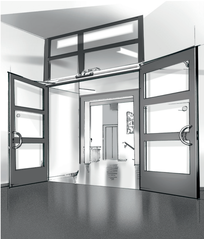
Beispielhafter Aufbau einer Brandschutztür mit Feststellanlage.
