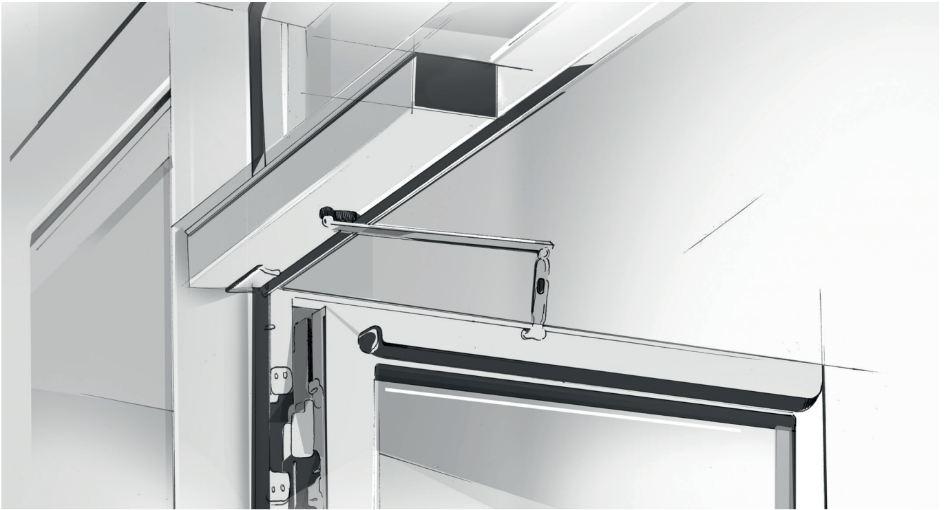
Beispielhafter elektromotorischer Antrieb mit Sensorleisten.
