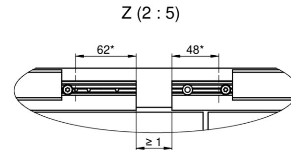
\* durch kürzen des GF Befestigungsprofils um 62mm und des SF Befestigungsprofils um 48mm kann der Bandabstand um 110mm reduziert werden
