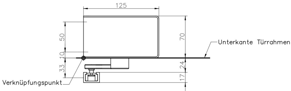
Bohrbild für Befestigungsbohrungen ETS 42 und Gleitschiene
