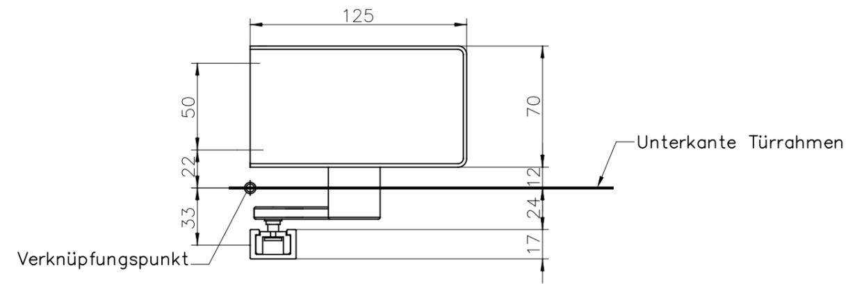
Bohrbild für Befestigungsbohrungen ETS 42 und Gleitschiene
