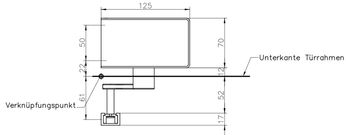
Bohrbild für Befestigungsbohrungen ETS 42 und Gleitschiene
