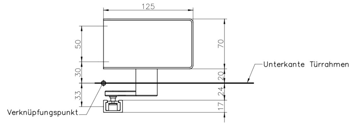
Bohrbild für Befestigungsbohrungen ETS 42 und Gleitschiene
