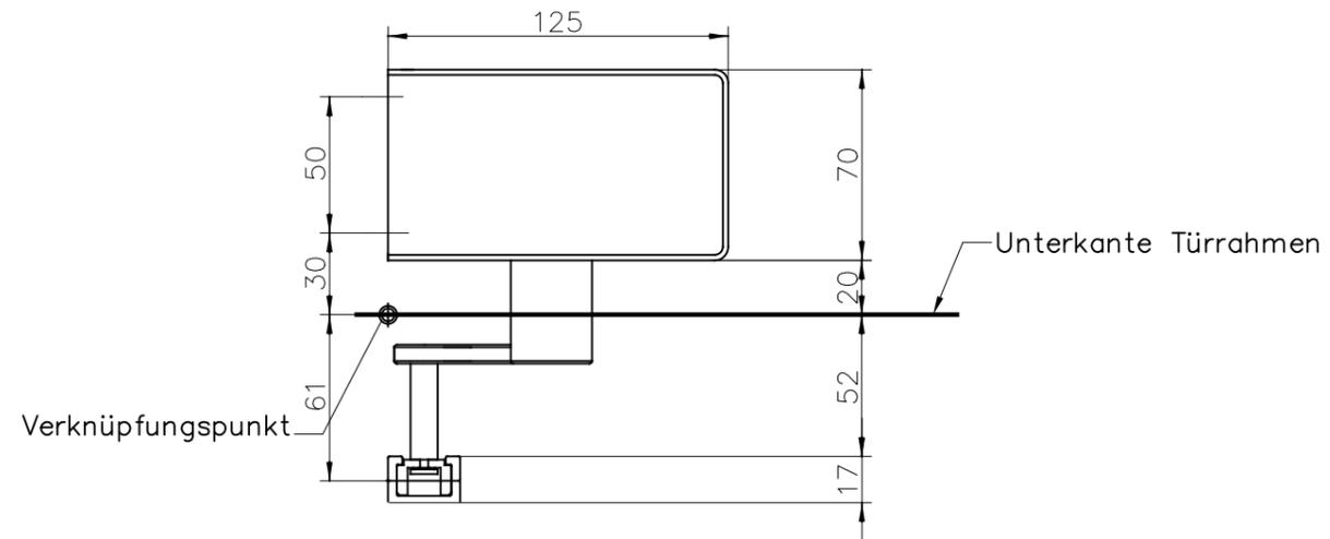
Bohrbild für Befestigungsbohrungen ETS 42 und Gleitschiene
