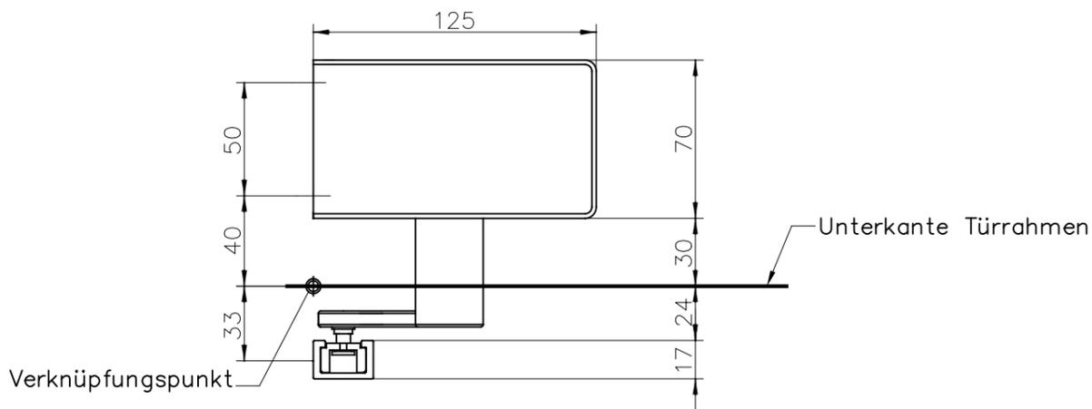
Bohrbild für Befestigungsbohrungen ETS 42 und Gleitschiene
