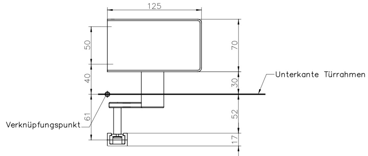
Bohrbild für Befestigungsbohrungen ETS 42 und Gleitschiene
