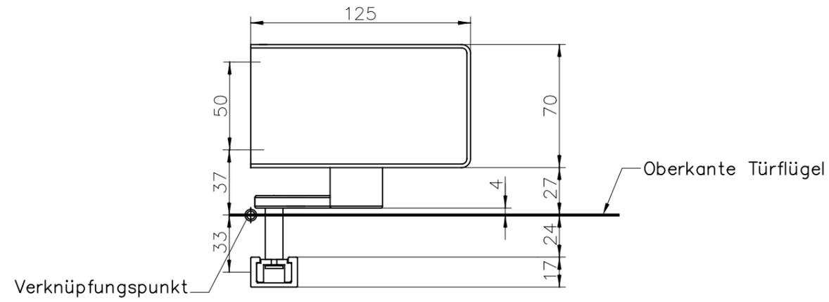
Bohrbild für Befestigungsbohrungen ETS 42 und Gleitschiene
