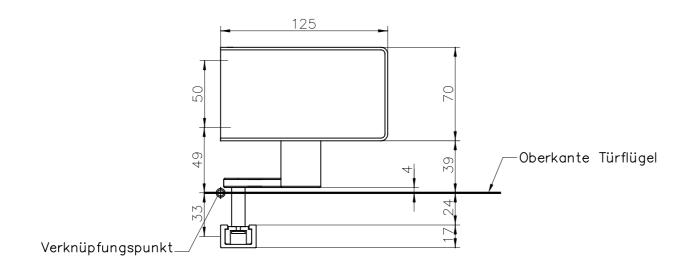
Bohrbild für Befestigungsbohrungen ETS 42 und Gleitschiene
