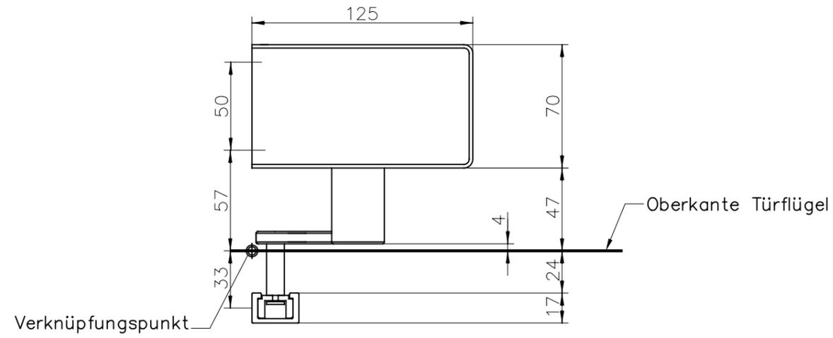
Bohrbild für Befestigungsbohrungen ETS 42 und Gleitschiene
