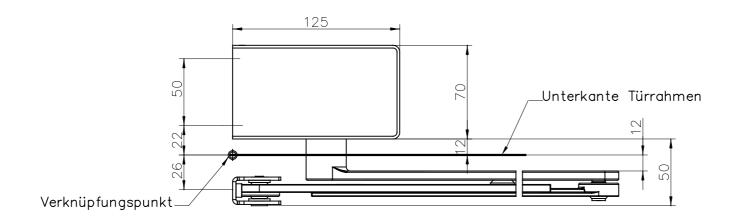
Bohrbild für Montageplatte und Gleitschiene
