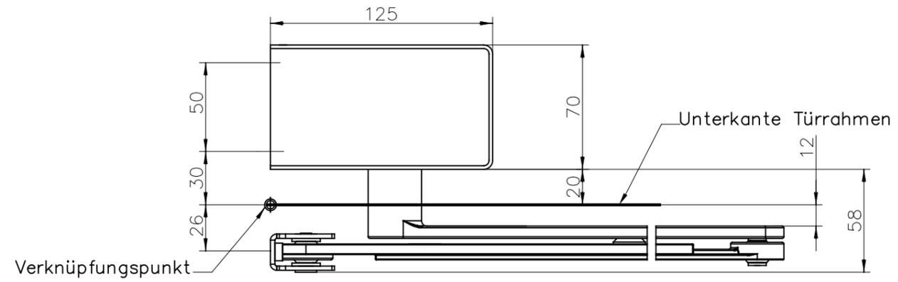
Bohrbild für Montageplatte und Gleitschiene
