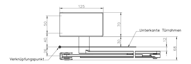
Bohrbild für Montageplatte und Gleitschiene
