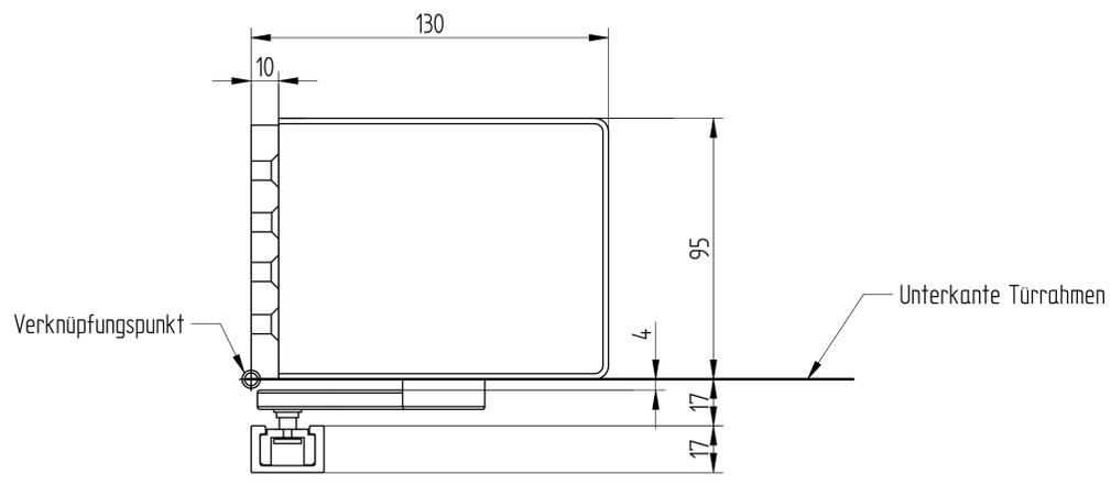
Bohrbild für Montageplatte und Gleitschiene
