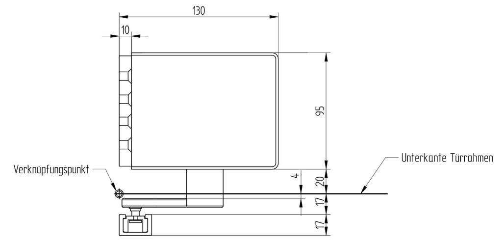
Bohrbild für Montageplatte und Gleitschiene
