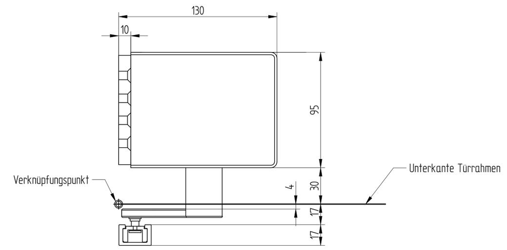
Bohrbild für Montageplatte und Gleitschiene
