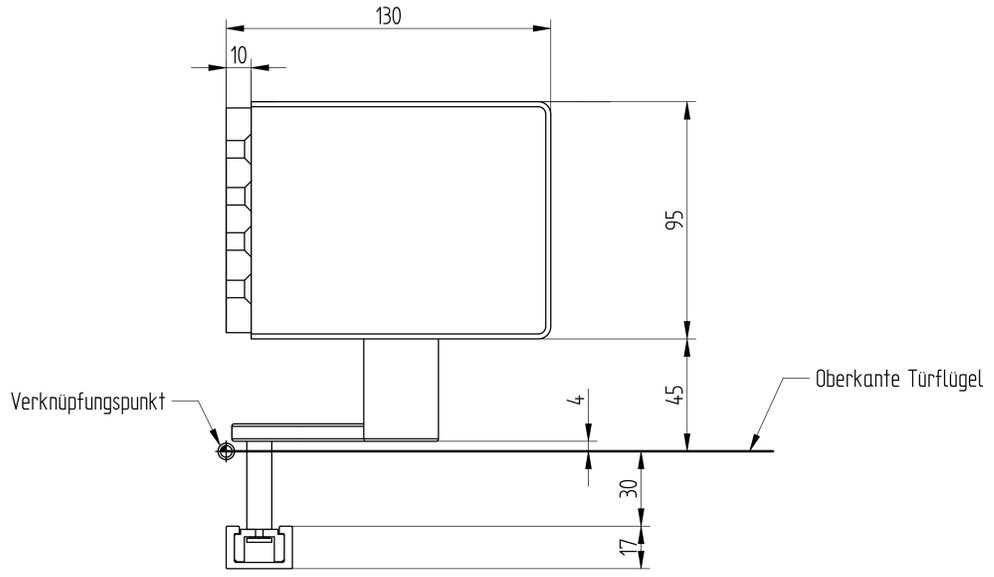
Bohrbild für Montageplatte und Gleitschiene
