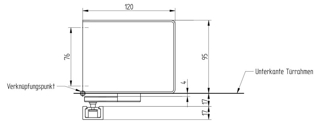
Bohrbild für Befestigungsbohrungen ETS 73 und Gleitschiene
