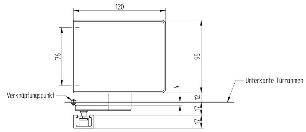
Bohrbild für Befestigungsbohrungen ETS 73 und Gleitschiene
