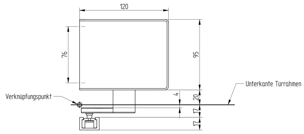
Bohrbild für Befestigungsbohrungen ETS 73 und Gleitschiene
