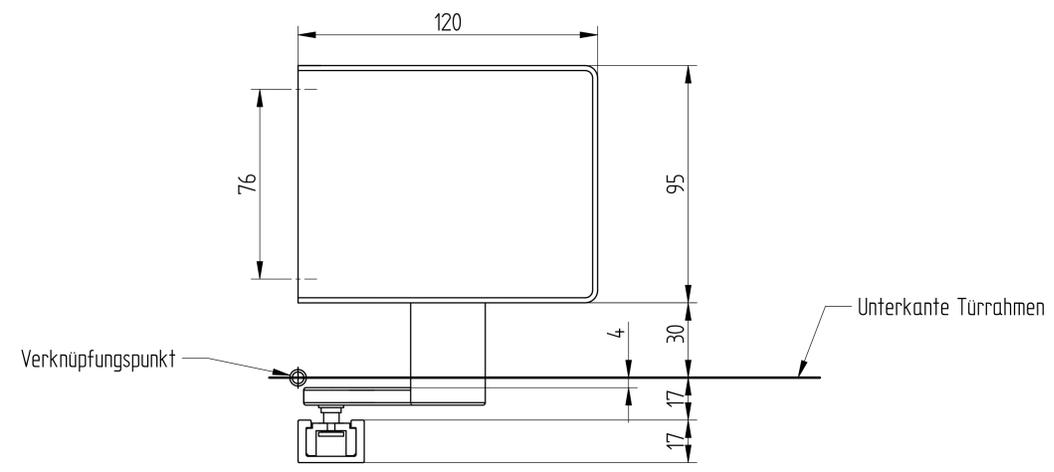
Bohrbild für Befestigungsbohrungen ETS 73 und Gleitschiene
