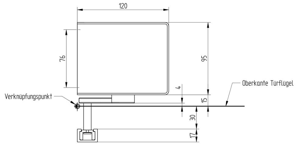
Bohrbild für Befestigungsbohrungen ETS 73 und Gleitschiene
