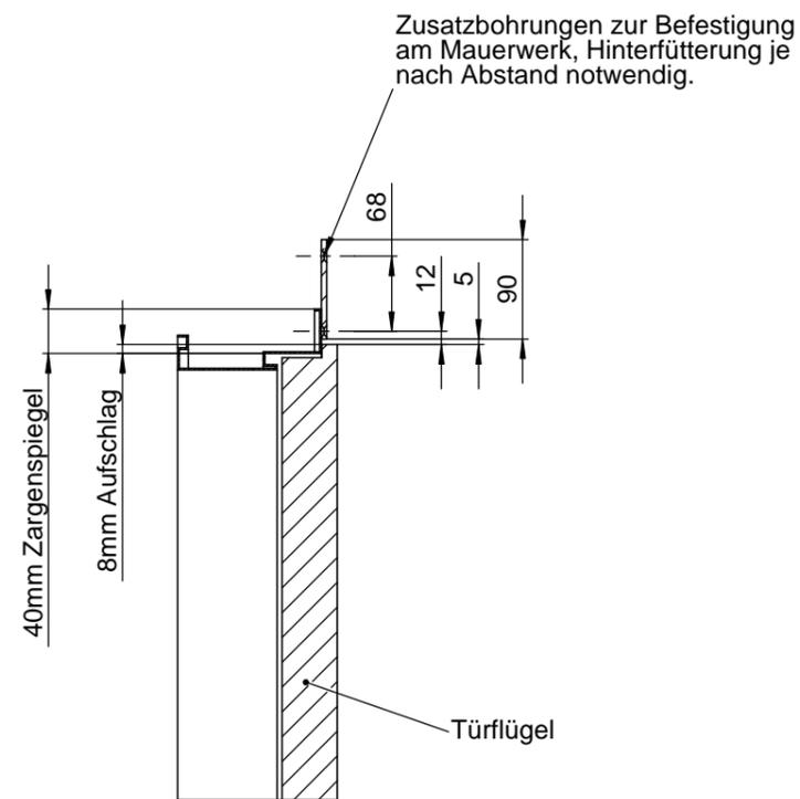
Minimum 70mm Zargenspiegel für Direktbefestigung ohne Adaptionprofil.
