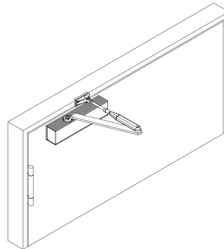
Anbauvariante Montageplatte + Adaptionprofil EN 3
