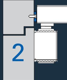
Die Montage mit Standardprofil (ADP 20) wird verwendet, wenn die Zarge bereits mit dem Montagebohrmaß 120/428,5 mm vorgerichtet wurde, z.B. bei Stahlzargen oder bei Austausch/Nachrüstung.
