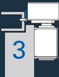
Das Adaptionsprofil (ADP 30) wird verwendet, wenn die Zargenkonstruktion eine stabile Befestigung der Gleitschiene nicht zulässt, z.B. bei Stahlzargen mit überfälzten Türen. Das Adaptionsprofil wird direkt auf die Zarge montiert. Die Gleitschiene kann jetzt stabil auf dieses ADP montiert werden. Es ist als Zubehör separat zu bestellen.
