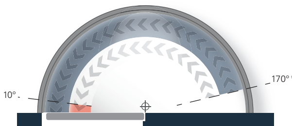
Diagramme de la force de fermeture d'ECO Newton TS-14 EN, côté opposé à la paumelle
