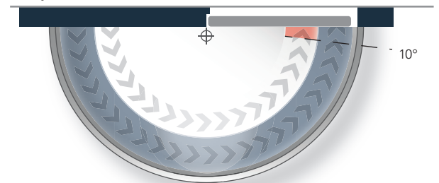
Diagramme de la force de fermeture d'ECO Newton TS-14 EN, côté paumelle
