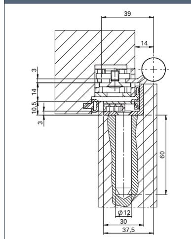
**Querschnitt mit Sicherheitszapfen (SI)**
