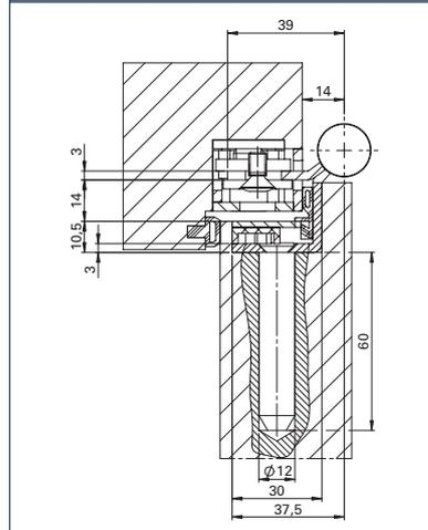
**Querschnitt mit Sicherheitszapfen (SI)**
