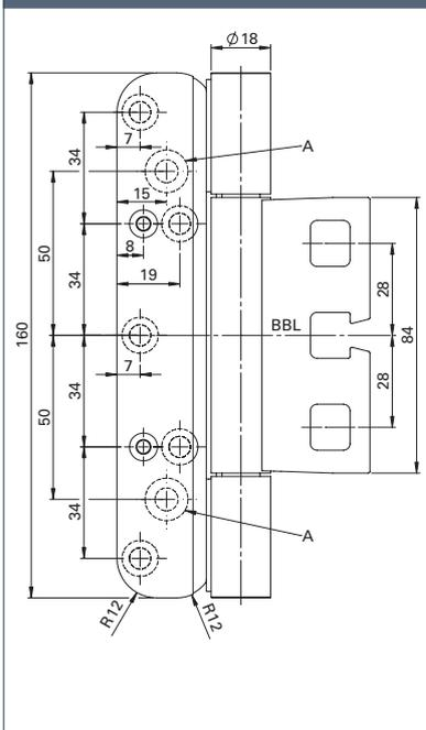
**Querschnitt mit Tragzapfen (TZ)**
