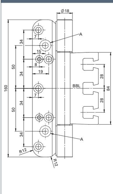
**Querschnitt mit Tragzapfen (TZ)**
