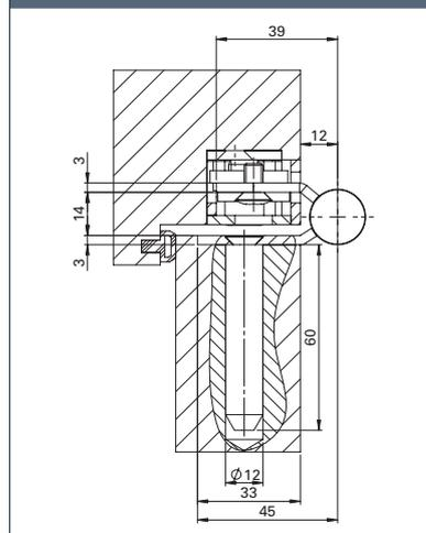
A: Nur bei Ausführung mit Tragzapfen. ■ Aufnahmeelement 3D Serie OBX ist separat zu bestellen. Tragzapfen/Schrauben sind separat zu bestellen.
