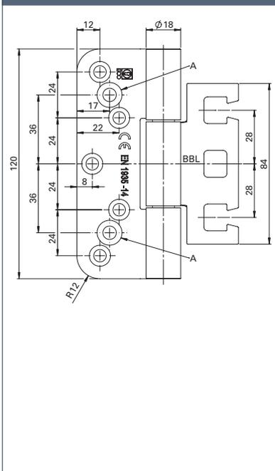
**Querschnitt mit Tragzapfen (TZ)**
